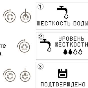
3. Нажмите на центральную кнопку дискретного переключателя для подтверждения установленных значений уровня жесткости воды. Индикация на дисплее «ПОДТВЕРЖДЕНО».
